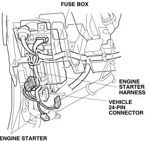
ENGINE STARTER HARNESS 24-PIN CONNECTOR
